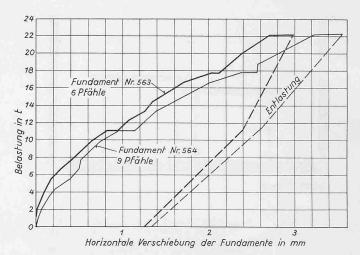
Bild 18. Versuchsresultate: horizontale Verschiebung der Fundamente; für zwei Fundamente
