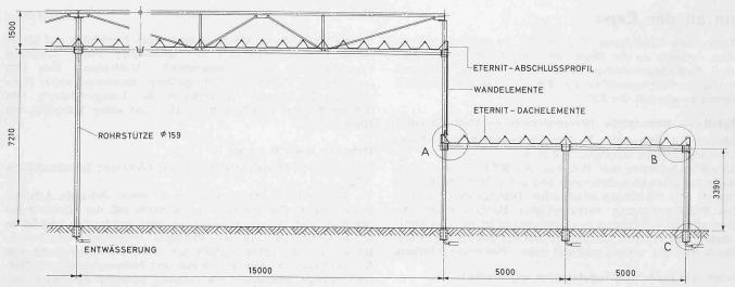
Bild 2. Schnitt 1:170 durch die Hallenkonstruktion
