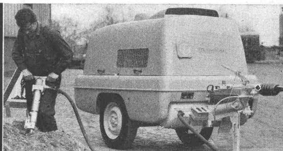
neuer, lärmarm, vollkommen luftgekühlter 4 m 3 -Kompressor
