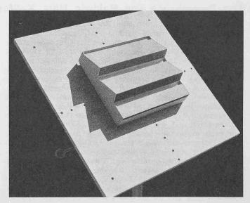
Bild 2. Schattenmessung an einem Arbeitsmodell (Shedbau)
