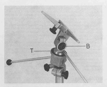
Bild 3. Gelenkkopf des Schattenmesstisches mit der Einstellung von Breitengrad (B) und Tageszeit (T)
