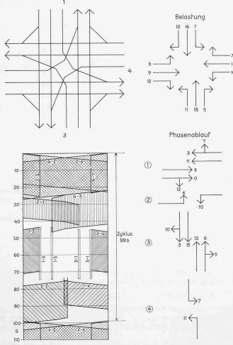
Bild 14. Das Zeit-Weg-Diagramm für die Leistungsberechnung einer signalgesteuerten Kreuzung mit der Belastungsverteilung nach Tabelle 3
