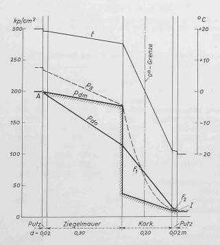
Bild 2. Verlauf der Temperatur t, des Sättigungsdrukkes  $p_s$  und des Dampfdruckes  $p_d$  in der Aussenwand eines Tiefkühl-Stapelraumes ohne und mit Dampfsperre in Abhängigkeit von der Wandtiefe
