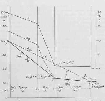
Bild 3b. Darstellung in Abhängigkeit von der Grösse  $\mu d$  bei einer Ausführung ohne Dampfsperre und mit starker Feuchtigkeitsausscheidung
