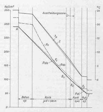
Bild 7. Bestimmung der Ausscheidungszone in der Innenwand eines Kühlraumes unter Berücksichtigung der Kondensationswärme; Darstellung in Abhängigkeit von den Grössen  $\mu d$
