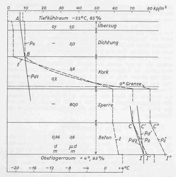
Bild 6. Temperatur- und Druckverlauf in einer Kühlhausdecke mit Dampfsperre in Abhängigkeit von den Grössen  $\mu d$ . Ueber der Decke befindet sich ein Tiefkühl-Stapelraum mit bei  $-22\,^{\circ}$  C, 83 %, unter ihr ein Obstlagerraum mit  $+4\,^{\circ}$ , 93 %
