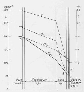
Bild 3a. Darstellung in Abhängigkeit von der Wandtiefe.  $p_{do}$  Druckverlauf ohne Fliesen,  $p_{ds}$  scheinbarer Druckverlauf mit Fliesen
