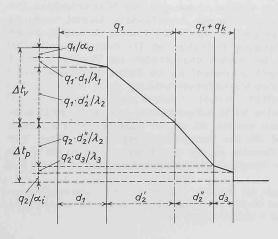
Bild 8 (links). Zur Berechnung des Temperaturverlaufs bei Anfall einer Kondensationswärme  $q_k=q_2-q_1$  cal/m²h
