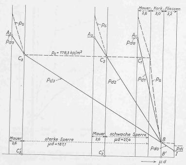
Bild 4. Prinzipieller Dampfdruckverlauf in Abhängigkeit von der Grösse  $\mu d$  der Wand nach Bild 2, jedoch mit Fliesen ohne Sperre  $(p_{d_1})$ , mit schwacher Sperre  $(p_{d_2})$  und mit starker Sperre  $(p_{d_3})$
