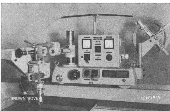
Universeller Lichtbogenschweissautomat für Gleich- oder Wechsel-
