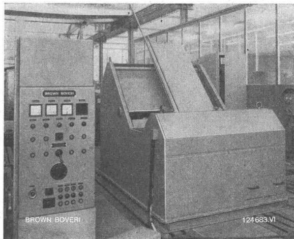
Mittelfrequenz-Induktions-Erwärmungsanlage mit Sägeautomat.
