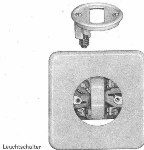
eingebauten Glimmlampe, kann diese — im Gegensatz zu anderen bekannten Leuchtschaltern — auch vom Nichtfachmann leicht und gefahrlos ausgetauscht werden. Hierzu muss lediglich die Frontscheibe abgeschraubt werden, worauf die ausgebrannte Glimmlampe aus einem auf der Rückseite der Frontscheibe angebrachten Becher herausgezogen werden kann.
