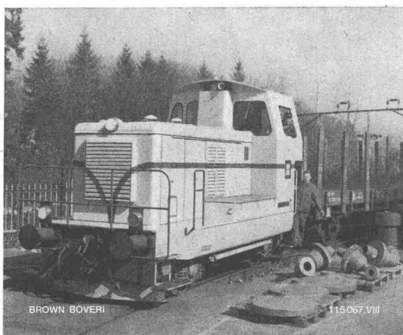
Dieselelektrische Industrielokomotive, 330 PS, 55 km/h, 11,7 t
