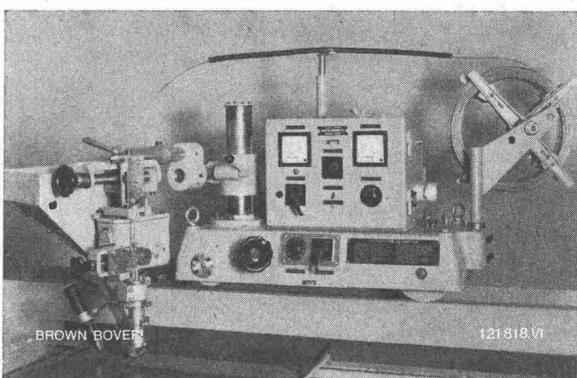
Universeller Lichtbogenschweissautomat für Gleich- oder Wechselstromschweissung, maximale Stromstärke 1200 A
