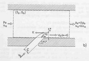
Bild 6. Ausschnitt aus dem Abluftkanal von der Länge  $\triangle$  x, für den der Impulssatz aufgestellt wird
