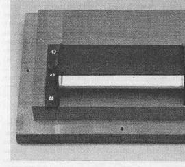
Bild 2. Modell der Absaugöffnung mit Haube, bestehend aus verstellbarem Deckel und festen Seitenblechen
