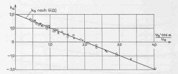
Bild 7. Vergleich der experimentell bestimmten Druckumsetzungskoeffizienten  $k_a$  mit den berechneten Werten nach Impulssatz; (O) nach Gl. (5) für eine Absaugöffnung mit Drosselschieber und lpha= 45°, (imes) nach Gl. (9) für eine Absaugöffnung mit Haube ( $lpha=0^\circ$ )
