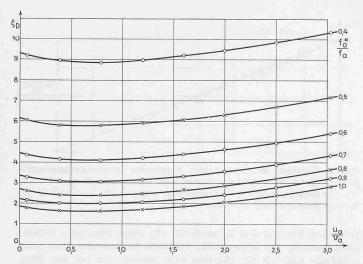
Bild 8. Drosselkoeffizient  $\zeta_D$  für eine Absaugöffnung mit Drosselschieber und Leitblechen. Messergebnisse für scharfe (O) sowie für abgerundete und scharfe (X) Eintrittskanten parallel zur Kanalaxe
