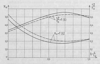
Bild 10. Dimensionsloser Druckverlauf  $\pi_a$  im Abluftkanal und Drosselstellung  $f_a*/f_a$  für Absaugöffnungen mit verstellbarem Schieber (gestrichelt) bzw. Haube mit verstellbarem Deckel (ausgezogen) beim berechneten Beispiel
