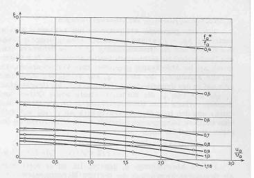
Bild 9. Drosselkoeffizient  $\zeta_D$  für eine Absaugöffnung mit Haube. Messergebnisse für scharfe (O) sowie für abgerundete und scharfe (X) Eintrittskanten parallel zur Kanalaxe. Die Messpunkte fallen für beide Ausführungsarten zusammen
