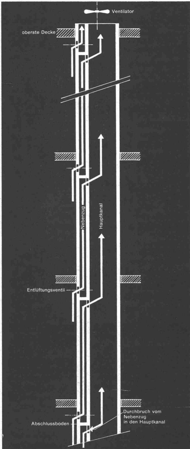
Das übliche Prinzip - für jeden Raum ein eigener Ventilationszug - braucht in Hochhäusern zu viel Platz. Um mit weniger Raum auszukommen und doch das am besten geeignete Material (korrosionssicheren ZZ Ziegelbeton) verwenden zu können, wurde ein ganz neues Entlüftungs-System entwickelt.
