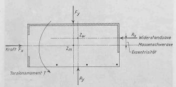
Bild 9. Wirkung von Torsionsschwingungen
