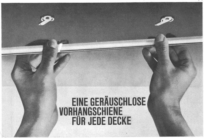
Spannfix heisst die Spezialvorhangschiene, welche mit einem Minimum von Schrauben auf allen Decken wie Beton, Leichtbau- und Schallschluckplatten, Metall, Holz, Verputz oder Gips befestigt wird. Kleine, flügelartige «Spanner» werden in Abständen von 40 bis 60 cm an die Decke geschraubt. Man legt das Profil auf die Spanner, dreht diese ein, und die Schiene sitzt fest. Spanner samt Schrauben bleiben unsichtbar, die Vorhangschiene scheint auf die
