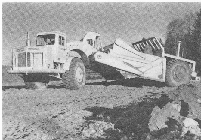
Euclid Doppelmotoren-Scraper TS-14, mit Allradantrieb, Einachs-Zugtraktor 148 PS, Scraper Fassungsvermögen 10,7 m 3 gestrichen, 12 m 3 gehäuft. Totalmasse: Länge 12,17 m, Breite 3,35 m, Gewicht 23,3 t, Tragkraft 21,3 t, Bruttogewicht 44,6 t.
