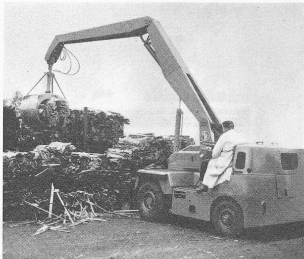
Mobilkran MSK 4 HG mit Spezial-Holzgreifer, Tragkraft 4 t. Für höhere Leistungsanforderungen steht der Mobilkran MSK 6 mit Holzgreiferausrüstung zur Verfügung. Diese Krane sind auch mit Normal-Kranhaken, mit Magnetausrüstung und mit Saughebevorrichtung erhältlich.
