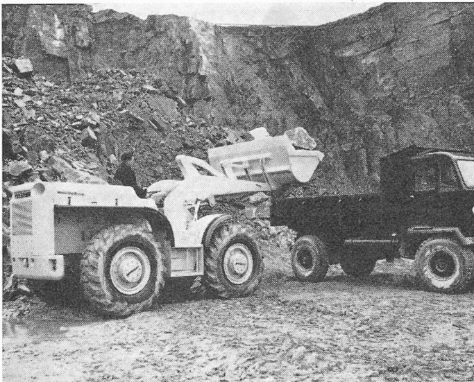
Chaseside-Lader SL. Drei Modelle mit Fassungsvermögen von 0,95 bis 1,85 m 3 und Motor von 96 bis 137 PS.
