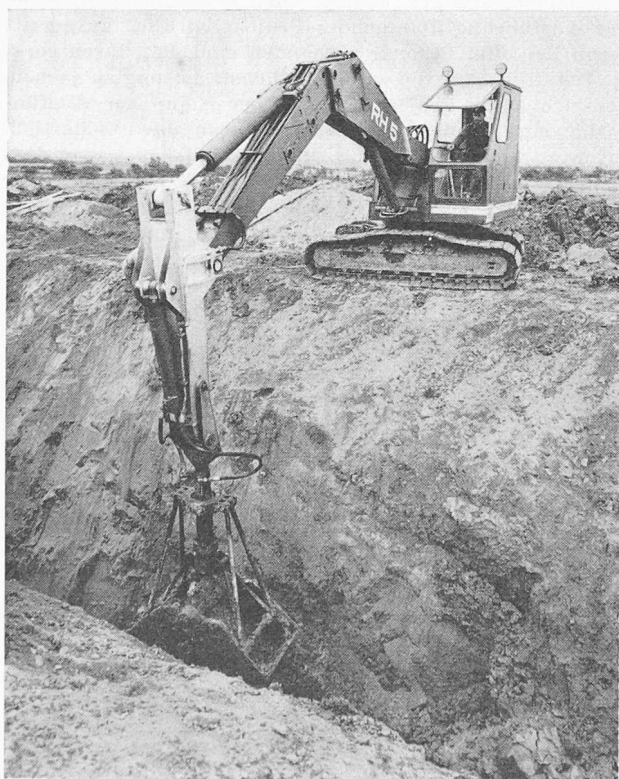
O+K-Universal-Raupen-Hydraulikbagger Typ RH5 mit Tief- löffelausrüstung. Fahrtrieb, Drehbewegung und Arbeitsbewegung erfolgen hydraulisch durch Oelmotoren, welche durch selbstregelnde Pumpen gespeist werden. Der Bagger passt seine Arbeitsgeschwindigkeit automatisch dem Arbeitswiderstand an, d. h. er arbeitet so schnell wie möglich und ist so stark wie nötig.
