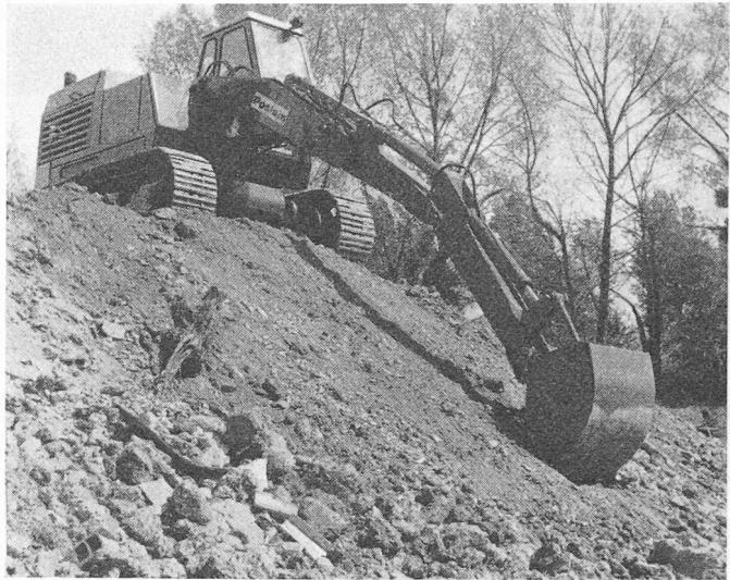
Hydrobagger Poclair TC 45 auf Raupen, vollkommen hydraulisch gesteuert, kann um 360° drehen. Tieflöffel 0,85 m breit, 0,3 m 3 Inhalt.
