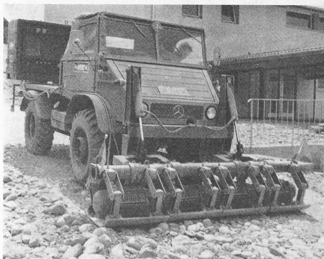
Brigel-Mehrplattenverdichter auf Unimog. Mit 4 Platten (Arbeitsbreite 2,40 m) kann er auf öffentlichen Strassen zirkulieren, kommt aber auch in schwierigem Gelände durch. Vibrationsplatten und Generator können in kurzer Zeit vom Unimog demontiert und jeder Teil für sich verwendet werden.
