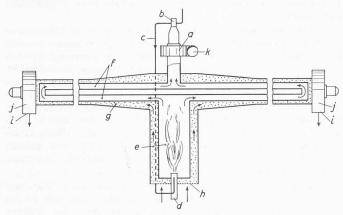
Bild 1. Längsschnitt durch den «Rheinland»-Lufterhitzer
