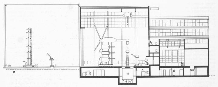
Bild 2. Längsschnitt durch das Hochspannungslaboratorium. In der Mitte das grosse Versuchslokal, rechts das kleine Prüflokal mit darüberliegenden Büroräumlichkeiten, links der Vorplatz mit ausgefahrenem Stossgenerator.
