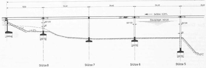
Bild 1. Steilerbachbrücke bei Sufers, Längsschnitt 1:600 (linke Hälfte)
