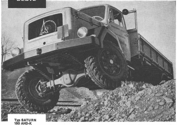
6 Zylinder luftgekühlter Dieselmotor 150 PS DIN Nutzlast bis 8 t
