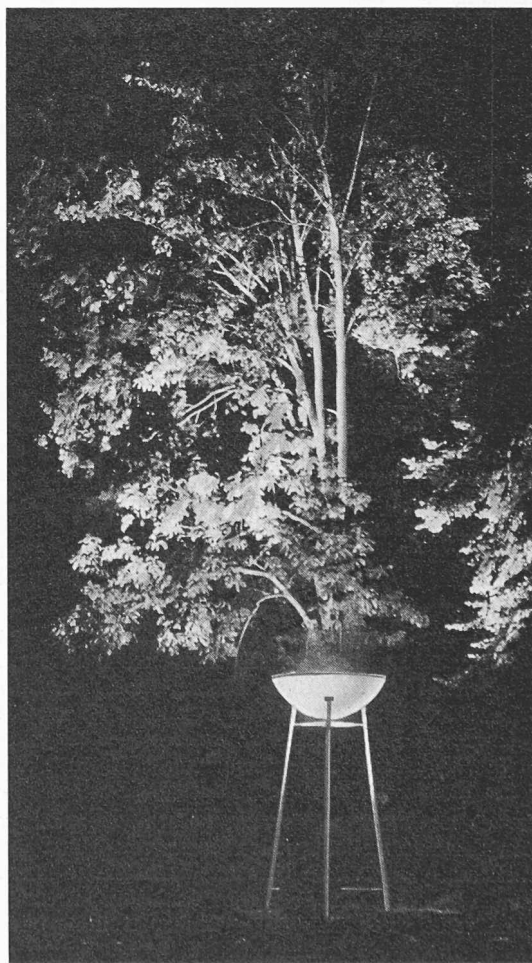
Bild 2 (rechts). Leuchtschale aus glasfaserarmiertem Polyester-Harz, 2 m Durchmesser, 0,70 m tief, auf unsymmetrischem Dreifuss, mit eingebautem Tragrahmen zur Aufnahme mehrerer Scheinwerfer verschiedener Funktion (Richtung, Farbe, Lichtstärken und Öffnungswinkel) für die Anleuchtung von Baumgruppen und Gebäuden. Gleichzeitig zur Direkt-Beleuchtung von Wegen, Vorplätzen, Rasen- und Gartenpartien. Bauhöhe zwischen 3 und 7 m je nach Augenhöhe benachbarter Besucher, zur Vermeidung direkten Einblicks. Leicht grüne Einfärbung (Tages-Farbtönen) und Diffusionszusatz im Harz zur Erhöhung der Lichtstreuung. Lichtdurchlässigkeit \approx 60\%
