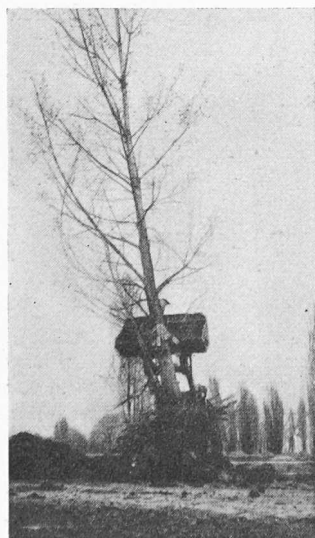
Verpflanzung grosser Bäume mit Hilfe eines dafür hergerichteten Schaufelladers
