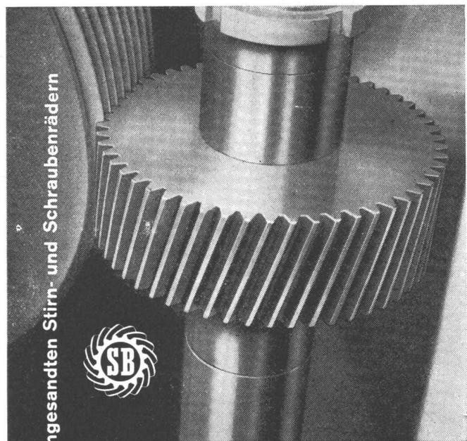
Zähneschleifen an eingesandten Stirn- und Schraubenräden
