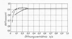
Bild 6. Abflusszahl eines breitkronigen Wehres mit Böschungsneigung 1:1 und verschiedenen Wehrhöhen s nach Bretschneider. Ausgezogene Linie s=0.25 m; strichpunktierte Linie s=0.50 m; gestrichelte Linie s=0.75 m
