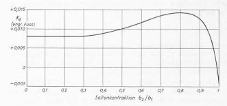
Bild 10. Zusatzglied  $K_b$  (engl. Fuss) zum Berechnen der «wirksamen» Breite des Ueberfallwehres mit Seitenkontraktion abhängig vom Breitenverhältnis  $b_2/b_1$  nach Kindsvater und Carter (Abflussgleichung s. Tabelle 2).
