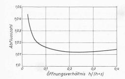
Bild 8. Abflusszahl C für scharfkantige Ueberfallwehre ohne Seitenkontraktion, berechnet aus dem S. I. A.-Beiwert in Abhängigkeit vom Oeffnungsverhältnis.
