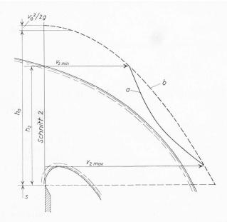
Bild 1. Geschwindigkeitsverteilung im Schnitt 2 über einem scharfkantigen Ueberfallwehr nach *Keutner*, Kurve a, verglichen mit der aus dem Torricelli-Weisbach-Ansatz berechneten Kurve b
