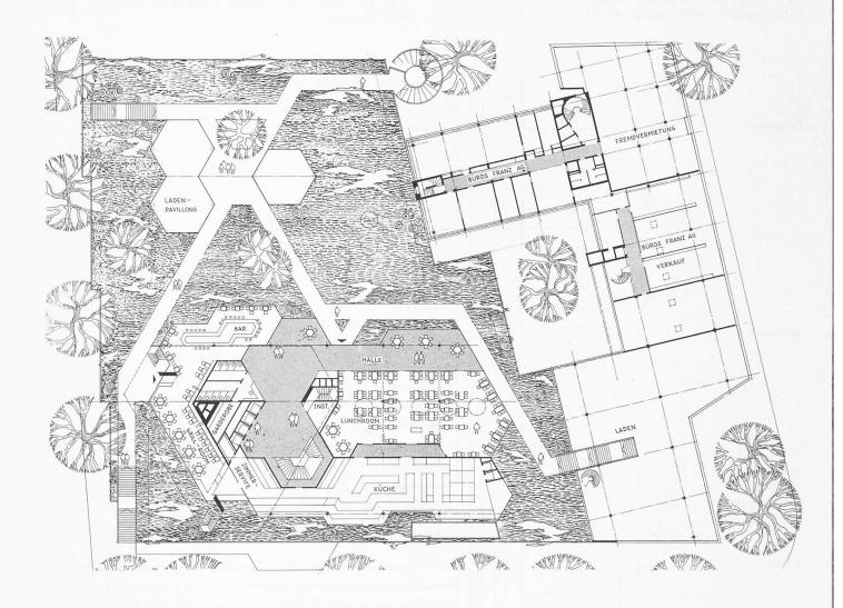
1. Obergeschoss 1:600 mit gesellschaftlichen Räumen des Hotels sowie parkähnlicher, öffentlich zugänglicher Anlage (mit Ladenpavillons) auf dem Dache des Erdgeschosses
