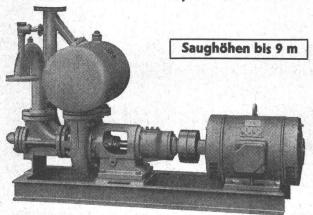
Leistungen 1—500 l/s. Kein Bodenventil. Keine Klappe im Saugstutzen. Keine Hilfs-Vakuumpumpe. Jederzeitiges automatisches Ansaugen auch nach Lufteintritt im Saugrohr. Keine reibenden, sich abnützenden Dichtungsflächen, daher störungsfrei auch bei Schlamm-, Sandund Kiesförderung.
