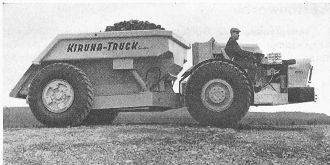
Bild 1. Diesel-Rückwärtskipper, Ladefähigkeit bis 21 t (15 m 3 )
