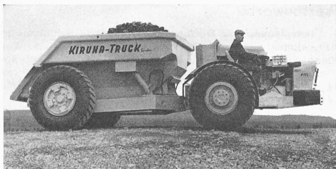
Bild 1. Diesel-Rückwärtskipper, Ladefähigkeit bis 21 t (15 m 3 )
