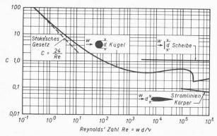
Bild 1. Koeffizient C des Strömungs- bzw. Sinkwiderstandes für Kugel, Scheibe und Stromlinienkörper nach L. Prandtl und G. J. Higgins
