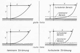
Bild 5. Gegenüberstellung der Geschwindigkeitsverteilung einer laminaren und einer turbulenten Strömung auf glatter bzw. rauher Gerinnesohle. Laminare Strömung (Re < 2500) kein Unterschied zwischen glatt und rauh. Turbulente Strömung (Re > 5000) grosser Unterschied zwischen glatt und rauh
