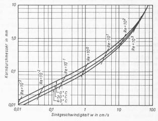
Bild 2. Sinkgeschwindigkeit von Quarzkugeln in Wasser verschiedener Temperatur. (Autor unbekannt)
