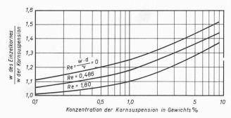
Bild 3. Einfluss der Konzentration von Kornsuspensionen auf die Sinkgeschwindigkeit "aach McNoron und Liu (gültig für Quarzsand in stehendem V asser)
