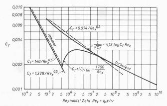
Bild 7. Widerstandskoeffizient  $C_f$  in dimensionsloser Darstellung für die ebene, glatte, in Strömungsrichtung eingetauchte Platte nach Blasius, Prandtl, Schlichting u. a. ( $C_f$  bezieht sich auf beide Plattenseiten)
