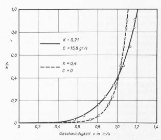
Bild 8. Geschwindigkeitsverteilung in offenem Gerinne von Reinwasser und einer Wasser-Sand-Suspension nach Vanoni-Brooks-Kennedy. (Wassertiefe 8,95 cm, Gerinnebreite 75,5 cm, Gefälle  $J_{\theta}=2,5$ %, K=10, Konstante nach v. Kármán, K=10,00 schwebstoffkonzentration)
