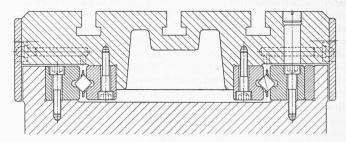
Bild 2. Lagerung von Kreuzrollenketten zwischen gehärteten Schienen beim Tisch einer Hobelmaschine
