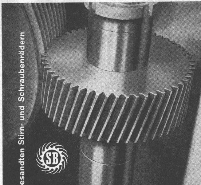
Zähneschleifen an eingesandten Stirn- und Schraubenräder
