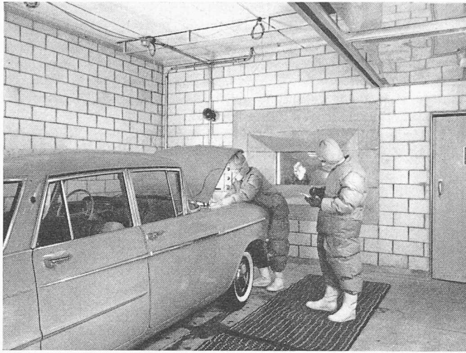
Bild 2. Grosse Kältekammer für Kaltstart- und Betriebsversuche an Motorfahrzeugen bei Temperaturen bis -50^{\circ}\text{C}
