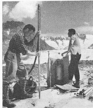
Bild 8. Thermischer Eisbohrer für langfristige Ablationsmessungen. Hinten: Ofen mit Umwälzpumpe für Heizflüssigkeit, die die Bohrspitze heizt; rechts: Ablationsgestänge. Grosser Aletschgletscher im Juli 1959
