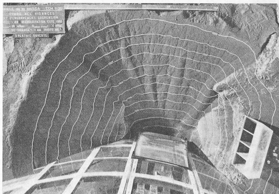
Bild 3. Modell der Staumauer Gebinden 1:30 mit Wasserfassung (rechts). Spülung bei minimalem Stau durch einen Grundablass. Der Durchmesser des Spültrichters beträgt etwa 75 m, die Neigung der Böschung etwa 1:1
