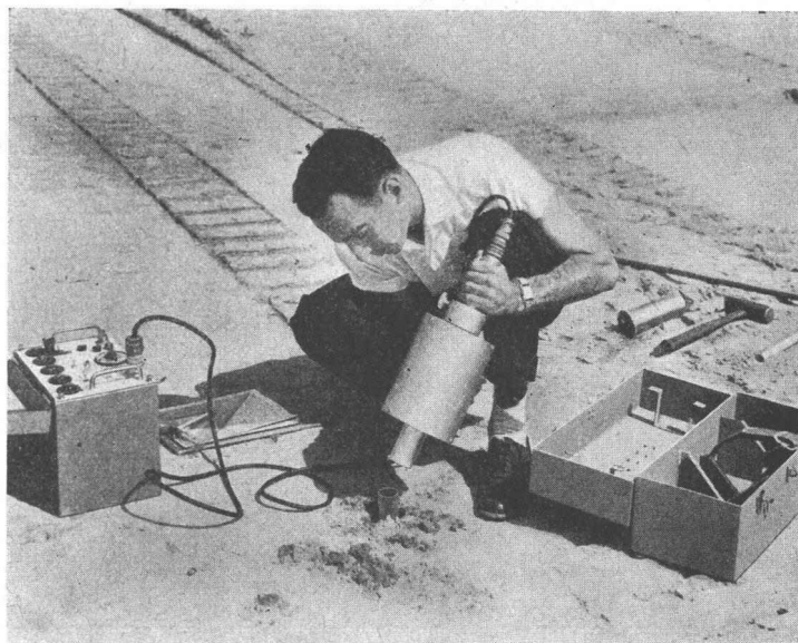
«d/M-Gauge» für schnelle Messung von Dichte und Wassergehalt im Boden
