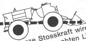
Die ganze Stosskraft wird bis zur Schaufelspitze in einer geraden, waagrechten Linie übertragen und erleidet keine „Knickverluste“.
