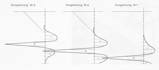
Bild 9. Beispiel eines ausgewerteten Messergebnisses; Verlauf des Wandbiegemomentes infolge einer Ringvorspannung in der Höhe der Momentenspitze. Der resultierende Momentenverlauf ergibt sich durch Superposition der dargestellten sieben Einzelfälle
