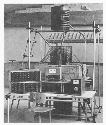
Bild 8. Modell mit Belastung und Messeinrichtung
