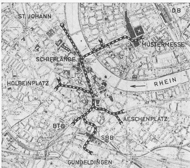
Bild 21. Dritte Bauetappe, Schifflände — St. Johann und Mustermesse; Einbezug der Birsigtalbahn
