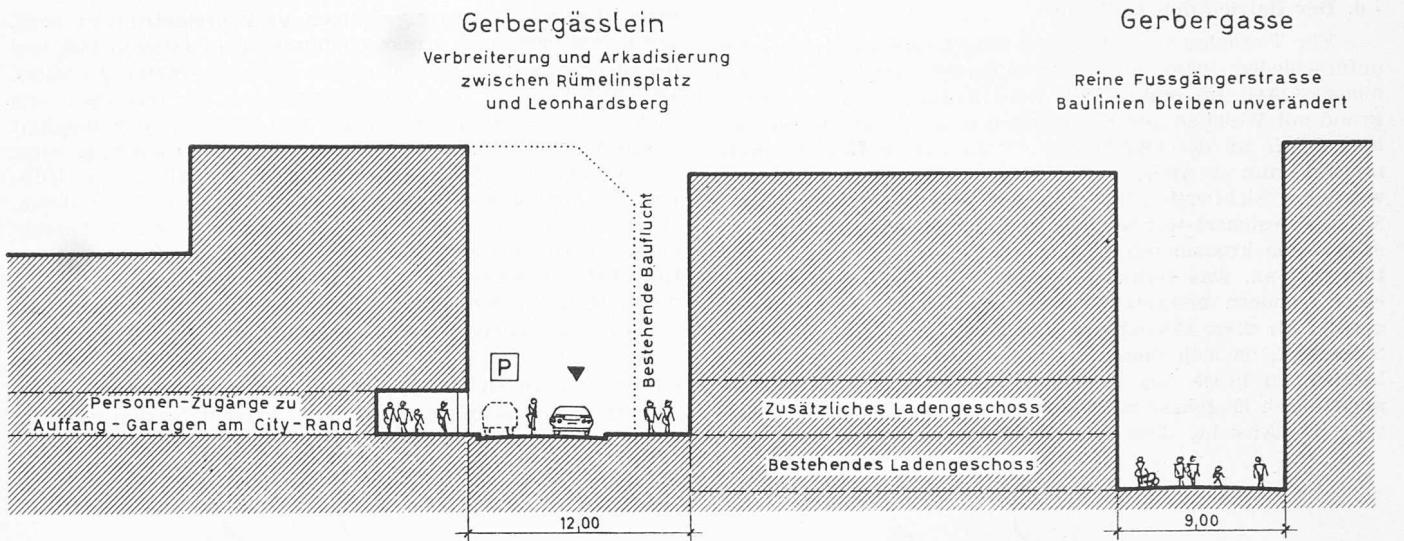
Bild 7. Querschnitt 1:400 durch die Talsohle in der City, nach Vorschlag der Fachverbände. Im ganzen Citygebiet nur noch Zubringer und Kurzparkierer. Durch Verbreiterung des Gerbergässleins wird die Gerbergasse zur Fußgängerstrasse
