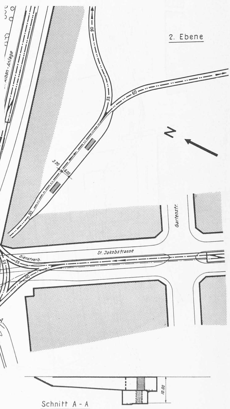
Bild 12. Tiefbahn-Station «Aeschenplatz». Mit Rücksicht auf die kreuzungsfreie Gabelung der Linien liegen die Bahnsteige für die beiden Fahrrichtungen übereinander. Für den Dienstverkehr ist eine Querverbindung St. Jakobsstrasse — St. Albananlage vorhanden. Die Treppen lassen sich so anordnen, dass ein Zwischengeschoss nicht erforderlich ist.
