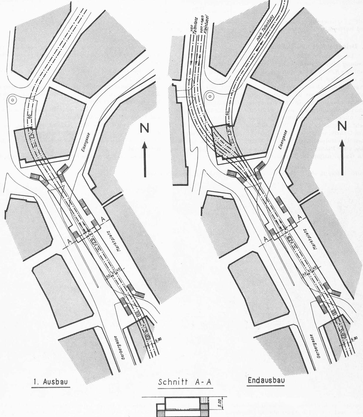
Bild 14. Tiefbahn-Station «Marktplatz», Pläne 1:1700, Schnitt 1:850. Die Station besitzt zwei seitliche Bahnsteige ohne Zwischengeschoss. Über Rolltreppen können alle wichtigen Ziele direkt erreicht werden
