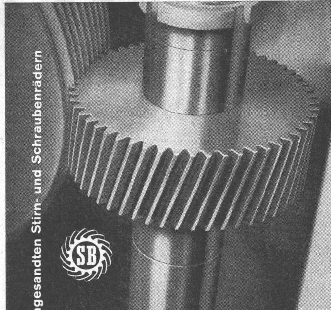
Zähneschleifen an eingesandten Stirn- und Schraubenrädern
