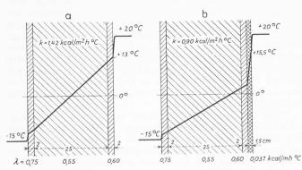
Bild 4. Temperaturverlauf in einer Aussenwand aus 25 cm Backsteinen mit beidseitigem Verputz; a ohne, b mit Dehna-Innenbelag von 15 mm Dicke. Man beobachte die Oberflächentemperatur auf der Innenseite der Wand
