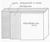
Bild 1. Aufbau des Dehna-Belags
