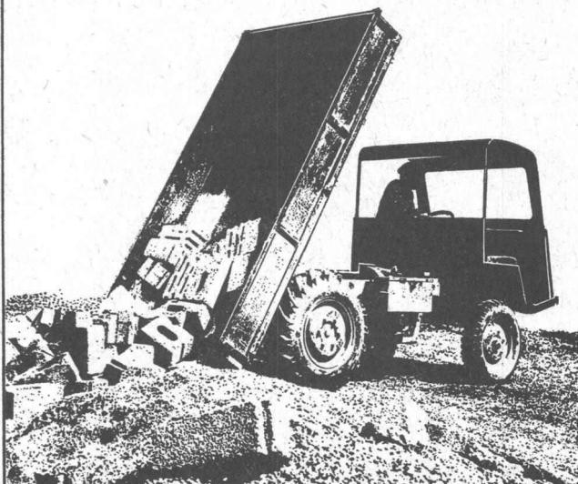
Rückwärts- oder 3-Seitenkipper, Stahlbrücke, luftgekühlter 30-PS-Motor, Differentialsperre, hydraulische 4-Radbremse etc. Das ideale Vielzweckfahrzeug für jede Baustelle:
