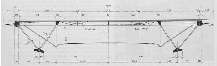
Bild 6. Längsschnitt 1:300 durch eine vorfabrizierte Autobahnüberführung der Strecke Genf-Lausanne
