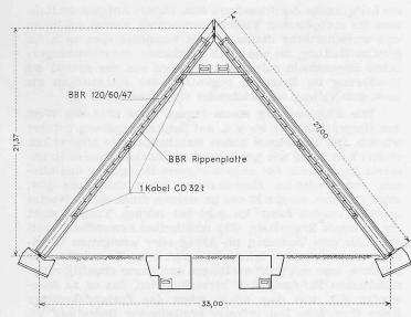
Bild 2. Querschnitt 1:400 durch die Steinlagerhalle einer Zementfabrik
