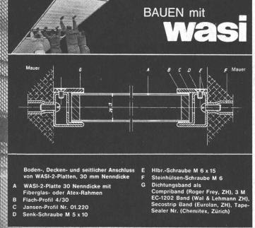
Lichtdurchlässige, unzerbrechliche und isolierende Fassadenwände
