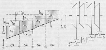
Bild 4. Vierteilige Dampfturbine mit vier, kühlwasserseitig hintereinandergeschalteten Kondensatoren
