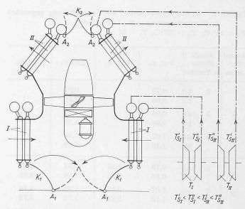
Bild 7. Vierteiliger luftgekühlter Kondensator einer Anlage mit zwei zweiteiligen Dampfturbinen
