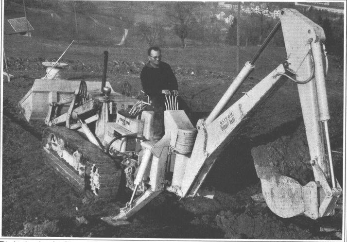
Die Ladeschaufel Oliver OC-96 hat sich bei uns gut eingeführt. Jede Woche kommt eine neue Maschine in Betrieb. Der Drehmomentwandler, das hydraulische Wendegetriebe und die unabhängige Kraftübertragung auf jede Raupe haben zu ihrem überraschenden Erfolg beigetragen.
