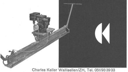
Master Vibrierbalken: ausgerüstet mit aufgebautem Benzinmotor, von einem Ende des Balkens regulierbar. Balken auf Schienenprofil, Auflagefläche 120 mm breit. Horizontal gelegene Spezialvibriernadel, bei Benzinmotorantrieb Fliehkraftkupplung. Modelle von 2-4 m Balkenlänge.
