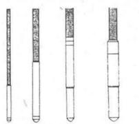
Schutzspannung von 48 Volt. Nur die Nadel geht auf die Schalung; die Antriebsgruppe bleibt ausserhalb des Arbeitsbereiches (Di-Ø 25, 38, 47, 66 82 mm stanz bis 100 m).
