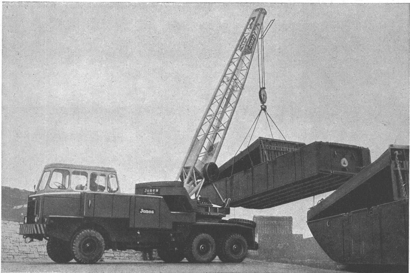
**Eine Kabine für Auto und Kran...** Ein Mann bedient in einer Kabine einen einzigen Motor zum Fahren (bis 48 km/h) und für die Kranbewegungen (bis 18 t Tragkraft) – das bietet der modernste Schnellfahr-Automobilkran mit Allradantrieb
