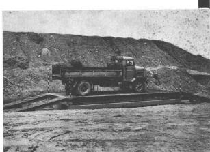
TRAWAC — die transportable Camionwaage (20 † Wägefähigkeit)
