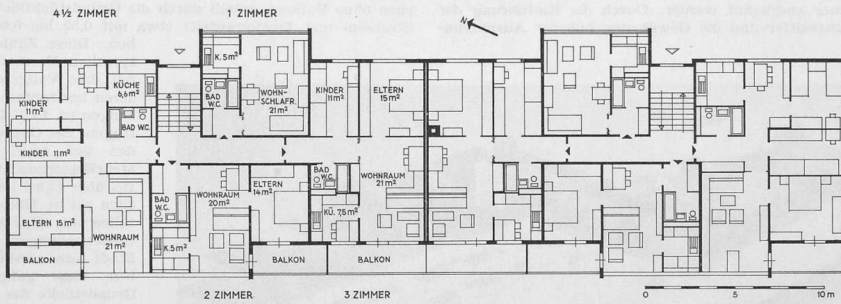
Normalgrundriss der viergeschossigen Bauten, 1:300
