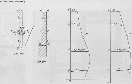
Bild 28. Modell  $M_1$ ; Spannungsverlauf längs eines Vertikalschnittes durch die Wand der Revisionsnische
