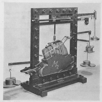
Bild 23. Modell M2 in der Belastungsvorrichtung
