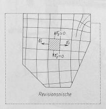
Bild 27. Modell  $M_1$ ; Hauptspannungstrajektorien in der Wand der Revisionsnische
