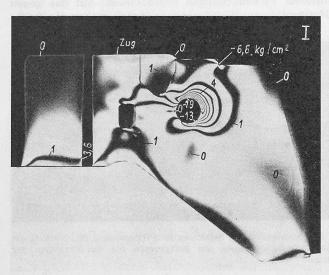
Bild 25. Modell  $\mathrm{M}_1$ ; Isochromatenbild des vertikalen Schnittes I (Bild 24)
