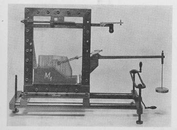
Bild 21. Pfeilermodell M<sub>1</sub> unter Belastung
