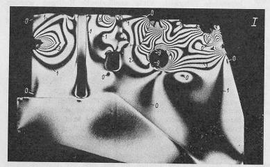
Bild 30. Modell  $M_2$ ; Isochromatenbild der Scheibe I (Bild 29)
