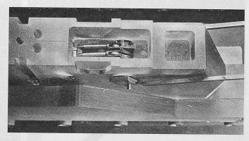
Bild 22. Anordnung der Belastung im Pfeilermodell  $M_1$ , Blick in die Revisionsnische von oben mit Hubpressen für das Betätigen der Schützen
