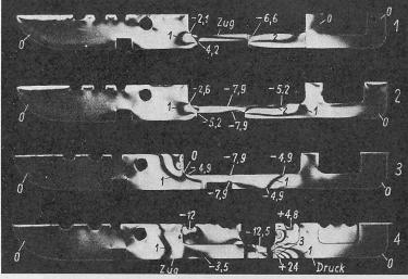
Bild 26. Modell  $M_1$ ; Isochromatenbilder der horizontalen Scheiben 1, 2, 3, 4 (Bild 24)
