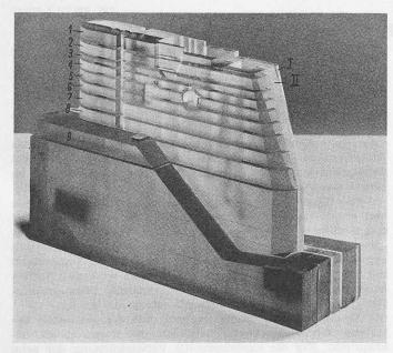
Bild 24. Anordnung der Schnitte am Modell  $\mathrm{M}_1$  für die dreidimensionale Untersuchung
