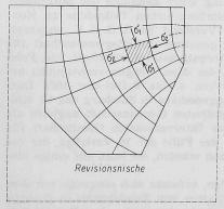
Bild 32. Modell M<sub>2</sub>; Hauptspannungstrajektorien in der Wand der Revisionsnische
