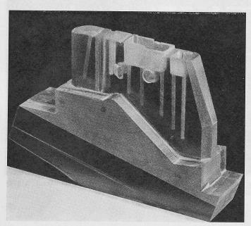
Bild 20. Pfeilermodell  $M_1$  aus Araldit F, Verkleinerung 1:125
