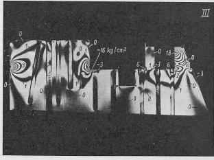
Bild 31. Modell M2; Isochromatenbild der Scheibe III (Bild 29)
