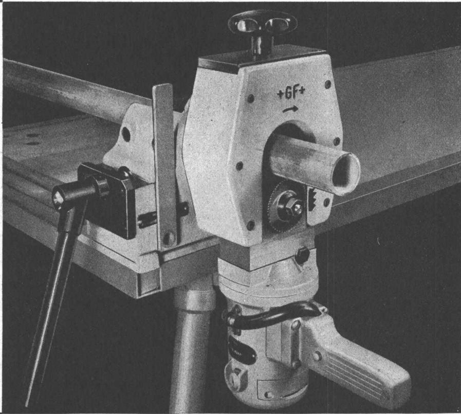
... mit der elektrischen +GF+ Rohrsäge RA 2
