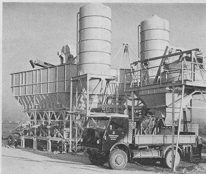
Bild 7. Vollautomatische transportable Mischanlage mit Materialsilos und Zwangsmischer für rd. 25 m 3 /h Beton. Bedienung 2 Mann
