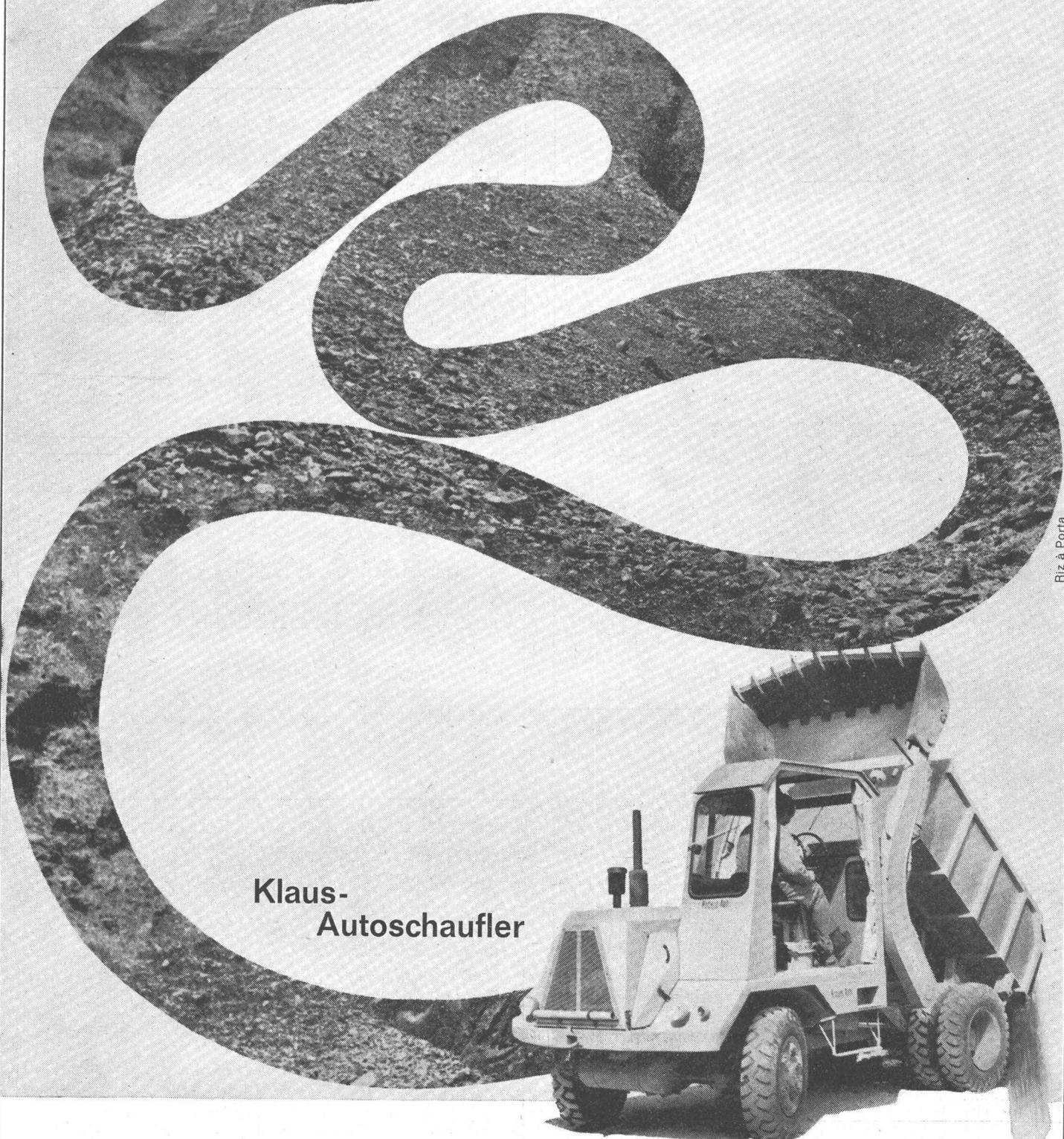
Der Klaus-Autoschaufler ist eine Kombination von Ladeschaufel und Muldenkipper; er spart daher Ihrem Betrieb einen Lastwagen mit Fahrer. Seine Schaufel fasst 750 l, die Kippmulde 4 m<sup>3</sup> (7 Tonnen Nutzlast). Er ist allrad-angetrieben und arbeitet vollhydraulisch.
