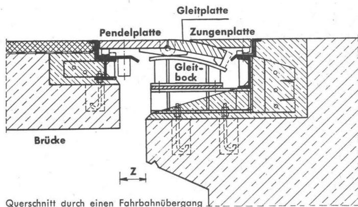
Querschnitt durch einen Fahrbahnübergang
